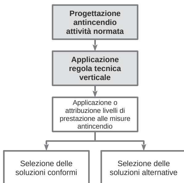
Illustrazione G 2.3: Progettazione antincendio delle attività normate
